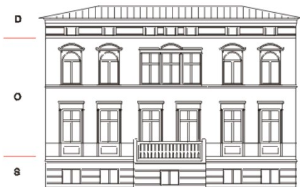
Gebäudezonen (S = Sockelzone, O = Obergeschosszone, D = Dachzone)
