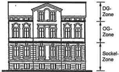
Drei horizontale Zonen in der Fassade
