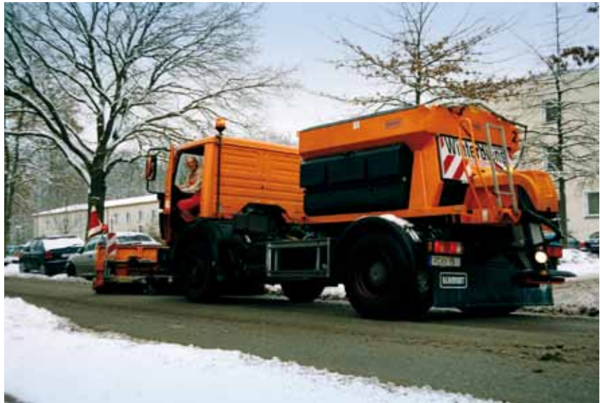
Moderne Technik gegen Schnee und Glätte: Die Fahrzeuge des Winterdienstes verfügen über GPS-Systeme zur Dokumentation der Einsätze. Sensoren ermitteln die Fahrbahntemperatur. Foto: STEP
