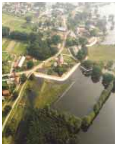
Bild 2: Notdeich zum Schutz der Ortslage Weisen, LK PR
