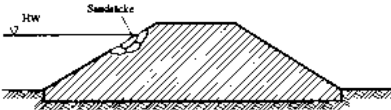
Abb. 19: Schadensstellenabsicherung mit Sandsäcken
