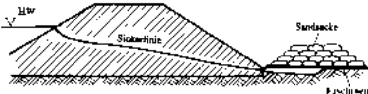
Abb. 31a: Auflast im Bereich der Gefahrenstelle
