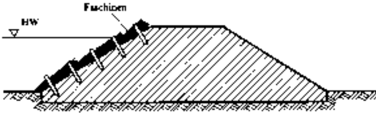
Abb. 18: Aufnageln von Faschinen
