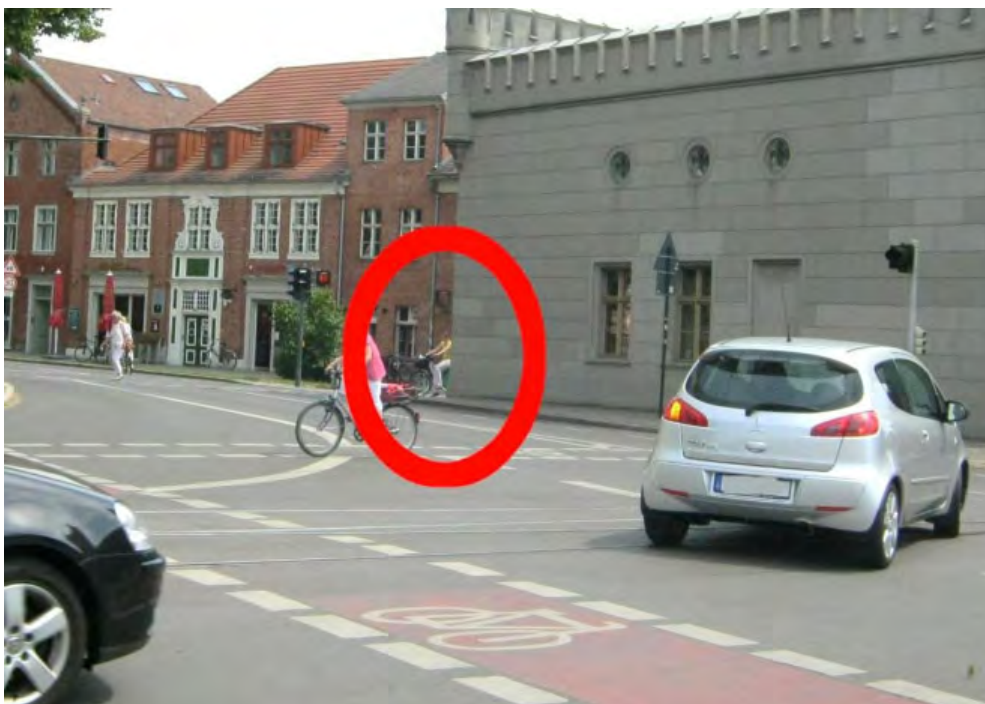
Abb. 28: Viele der Unfälle an der Kreuzung Nauener Tor sind auf schlechte Sichtbedingungen zwischen in die Kurfürstenstraße einbiegenden Kfz und von Süden kommenden querenden Radfahrern zurückzuführen (Sichtbehinderung durch Nauener Tor) (Luftbild: LHP 2009, Foto und Fotomontage: PGV)
