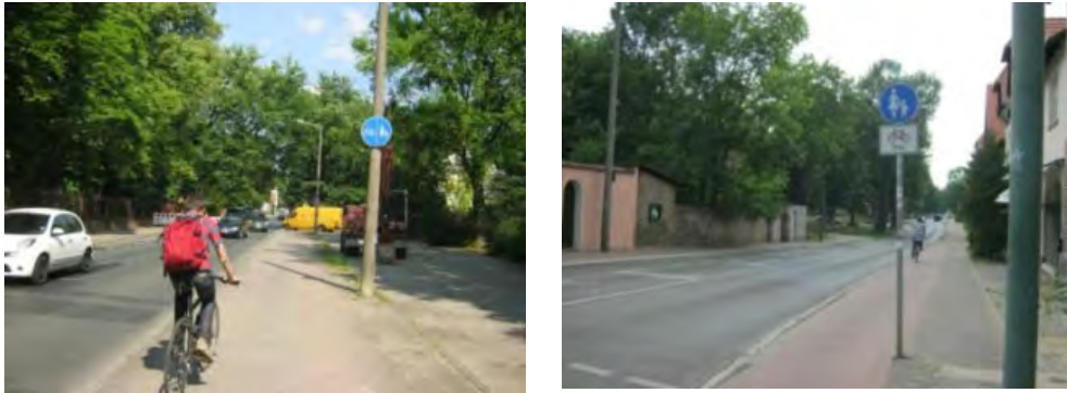
Abb. 102 Streckenweise Gehwegführungen des Radverkehrs im untersuchten Abschnitt der Templiner Straße: Links: Getrennter Geh- und Radweg auf der südlichen Straßenseite Rechts: Gehweg/Radfahrer frei auf der nördlichen Straßenseite (Fotos: PGV)
